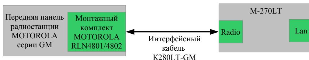
Рис. 4.2.2 Схема подключения операторского оборудования к контроллеру М-270LT, при работе интерфейса в режиме «Терминал GM».
