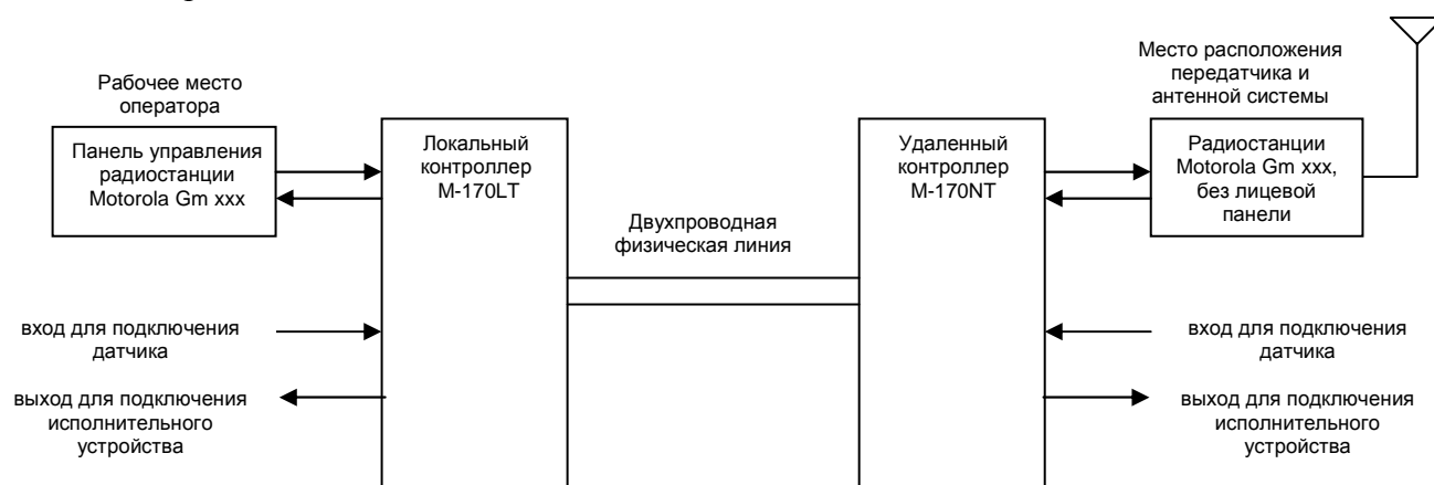
Рис.1. Организация дистанционного управления радиостанциями MOTOROLA серии GM.
