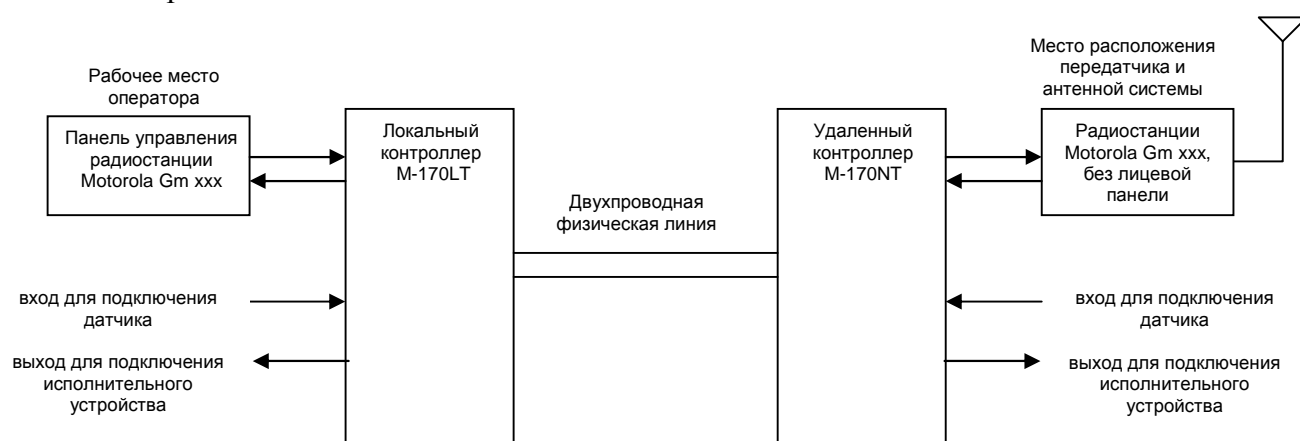
Рис.1. Организация дистанционного управления радиостанциями MOTOROLA серии GM.
