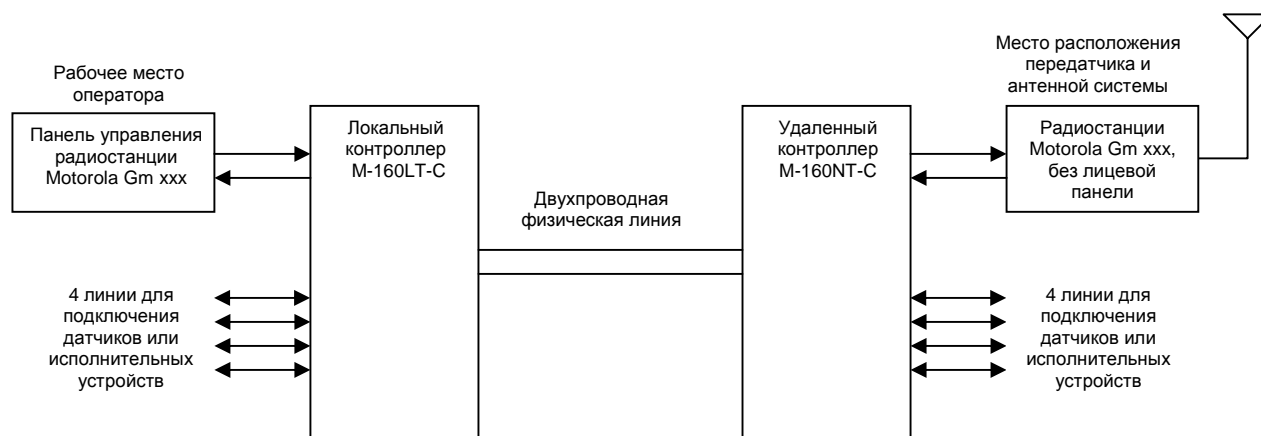
Рис.1. Организация дистанционного управления радиостанциями MOTOROLA серии GM.
