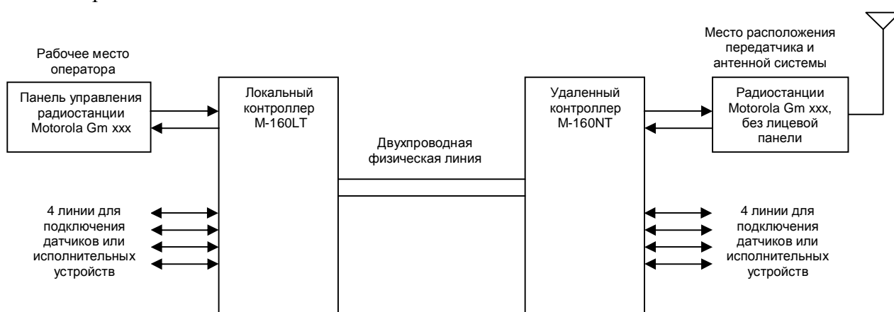
Рис.1. Организация дистанционного управления радиостанциями MOTOROLA серии GM.
